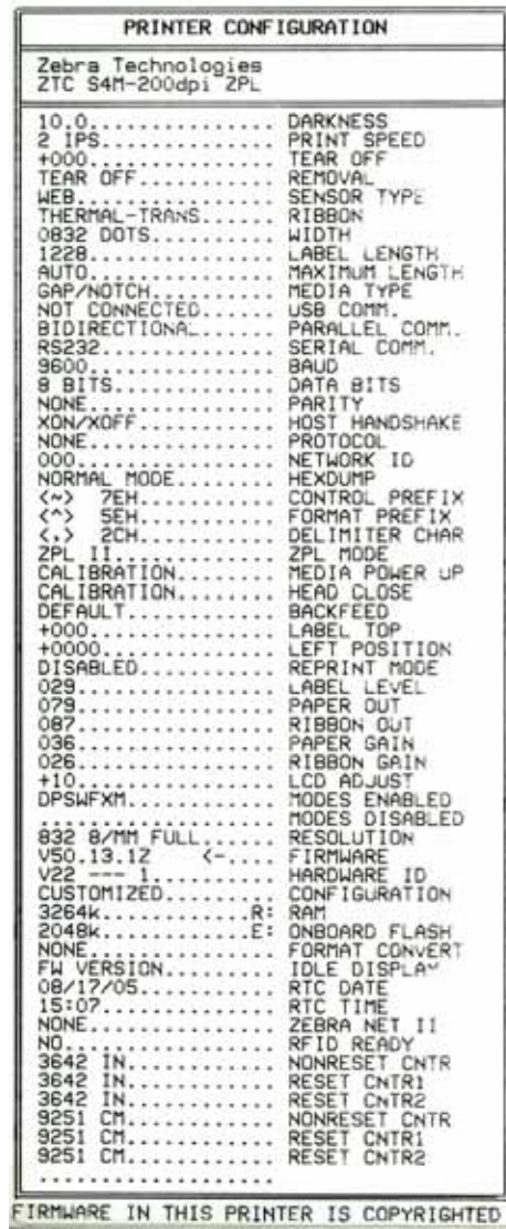
Рис. 17 • Образец этикетки с конфигурацией принтера
