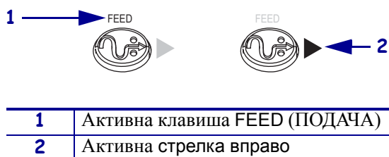
Рис. 4 • Пример активных клавиш панели управления
